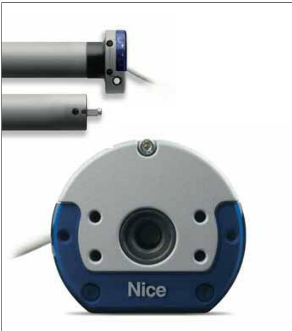
**Motore tubolare ideale per tende in cassonetto con manovra di soccorso manuale, finecorsa elettronico, centrale di comando e ricevitore integrati, controllo del movimento a encoder e recupero del telo.**
