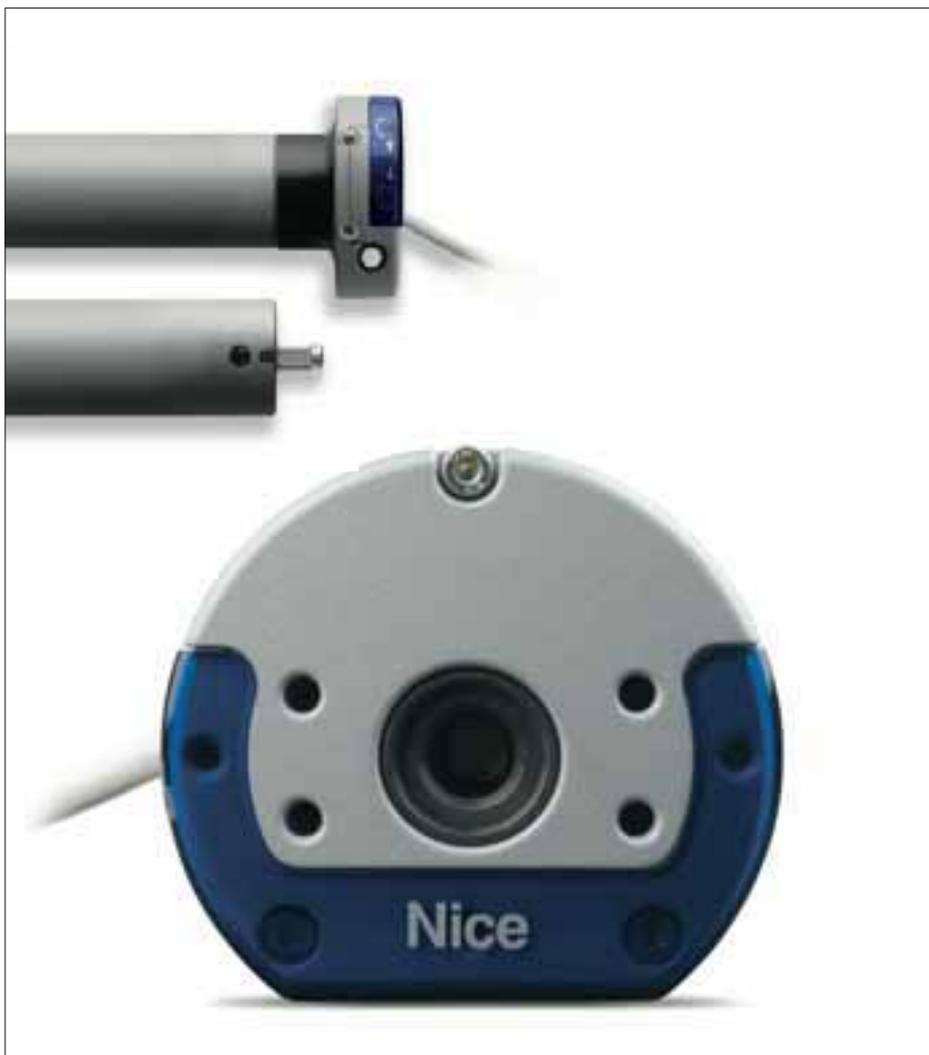
**Motore tubolare ideale per tende e tapparelle (anche da garage) con manovra di soccorso manuale e finecorsa meccanico, centrale di comando e ricevitore integrati.**
